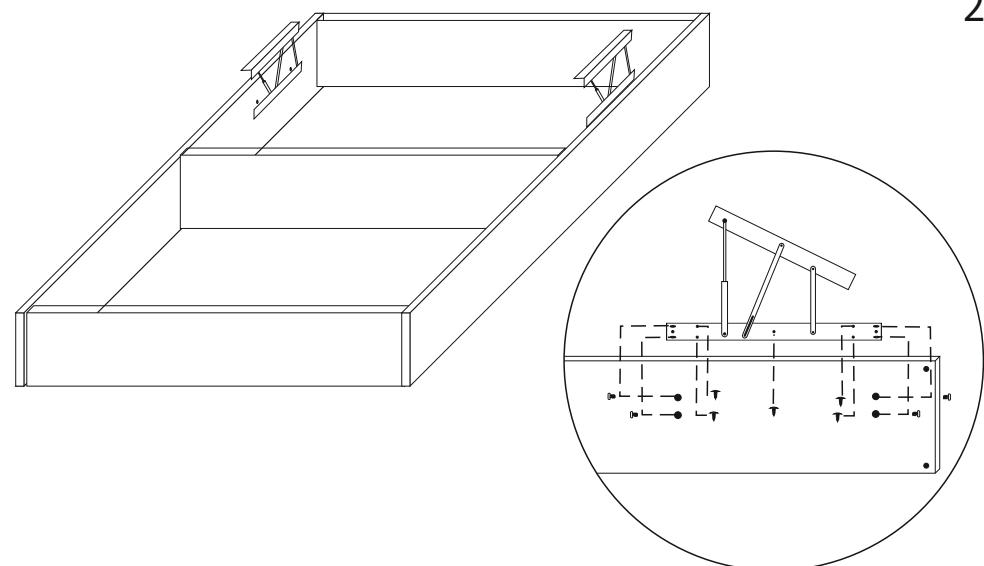
3. Крепится подъемный механизм с применением винтов (3) которые вкручиваются в пластиковые футерки, врезанные в боковины ящика
